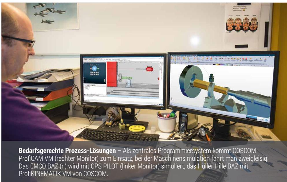
**Bedarfsgerechte Prozess-Lösungen** – Als zentrales Programmiersystem kommt COSCOM ProfiCAM VM (rechter Monitor) zum Einsatz, bei der Maschinensimulation fährt man zweigleisig: Das EMCO BAZ (r.) wird mit CPS PILOT (linker Monitor) simuliert, das Hüller Hille BAZ mit ProfiKINEMATIK VM von COSCOM.
